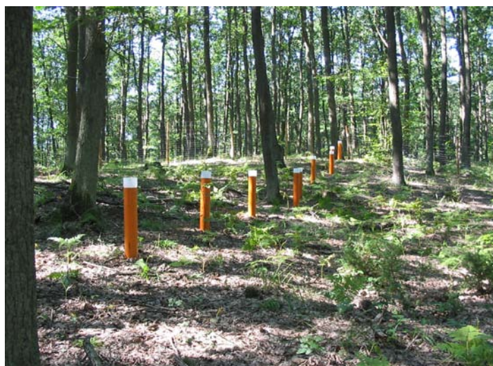
Fot. 2. Chwytniki podkoronowe do zbioru opadu mokrego na powierzchni w Chojnowie – fot. P. Lech
