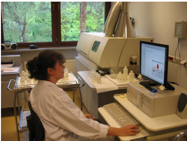
Fot. 6. ICP – aparatura do oznaczania zawartości metali w próbkach opadów podkoronowych i roztworów glebowych, fot. L. Kluziński
