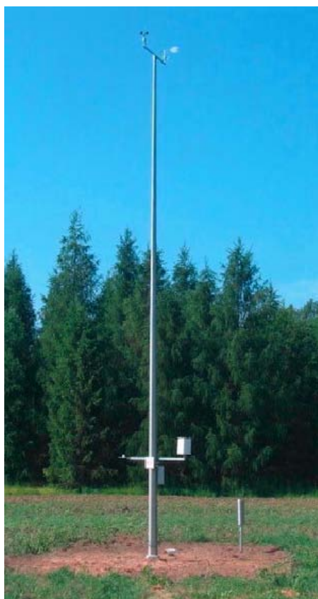
Fot. 7. Automatyczna stacja meteorologiczna na SPO II rzędu. w Nadleśnictwie Łąck
