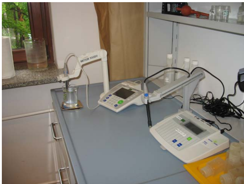
Fot. 5. pH-metr cyfrowy – pomiar pH opadów atmosferycznych, fot. L. Kluziński
