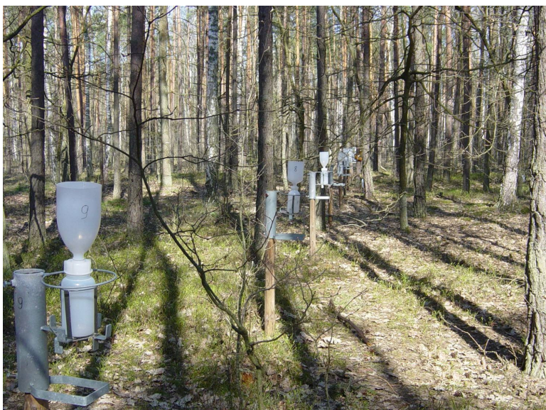
Fot. 7. Pomiar opadów podkoronowych. Foto G.Misiewicz,
