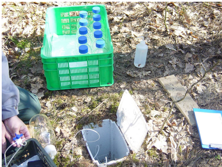
Fot. 8. Pomiar roztworów glebowych. Foto G. Misiewicz.
