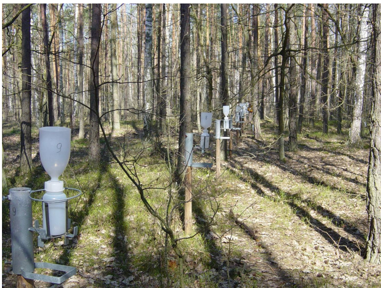
Fot. 7. Kolektory do pomiaru opadów podkoronowych. Nadleśnictwo Chojnów – fot. G.Misiewicz.
